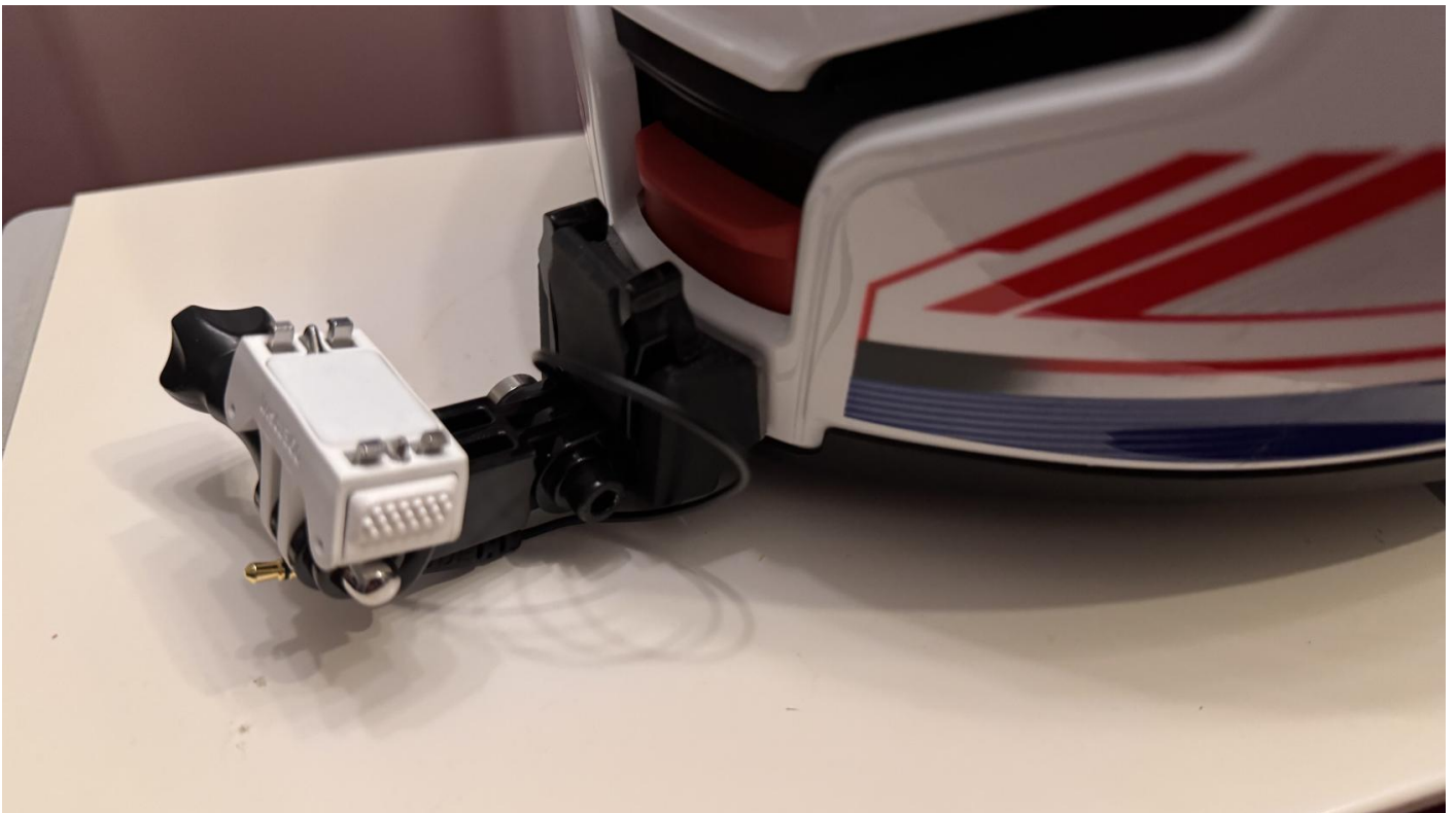
Wenn die Kamera nicht montiert ist, hält ein O-Ring den Mikrofon Stecker
